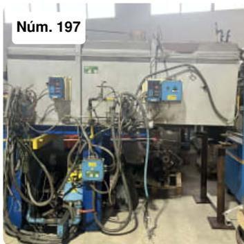
■ **Horno de fundición SIB FAG4 SAL 60.000 KCAL/H**
