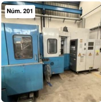
■ Centro de mecanizado vertical CNC con transportador de virutas MAZAK FH 480X
